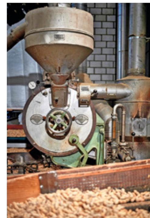
Die Maschine der Firma Geiser zum Rösten der Erdnüsse steht in Langenthal.
